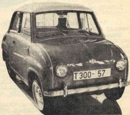
GERMANIA - La GOGGOMOBOL è la vettura alla quale arride il maggior successo in Germania. Viene costruita in due diversi tipi. La rappresentata a figura è munita di motore bicilindrico 250 cc. - velocità massima 85 Km/h - consumo 1 litro per 25-26 Km.
